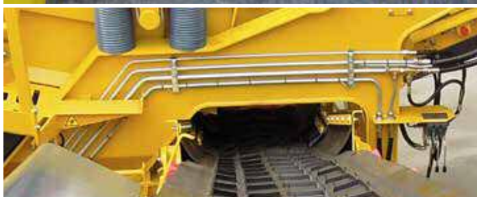
Стальные гидравлические линии
