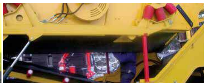
Короб грохота с гидравлическим подъемом
