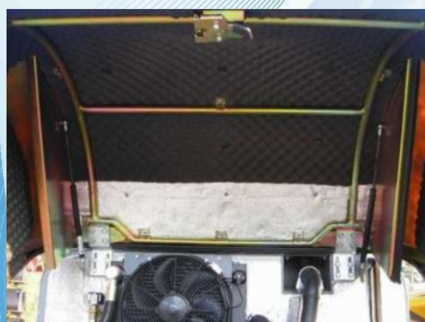
Капот с металлической рамой, амортизаторы закрывания капота
