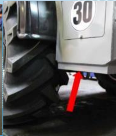
Капот с металлической рамой, амортизаторы закрывания капота
