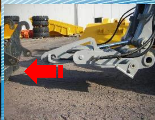
Быстросъемная навеска для замены дополнительного оборудования
